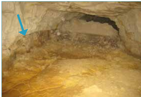
Illustration 1.8 : Visualisation du battement de la nappe souterraine sur les parois d'une cavité souterraine, Sarcé (72) [crédit Cerema Ouest, 2010]
